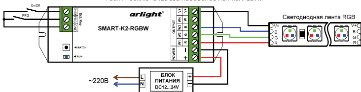
Рис.2. Подключение светодиодной ленты RGB.
